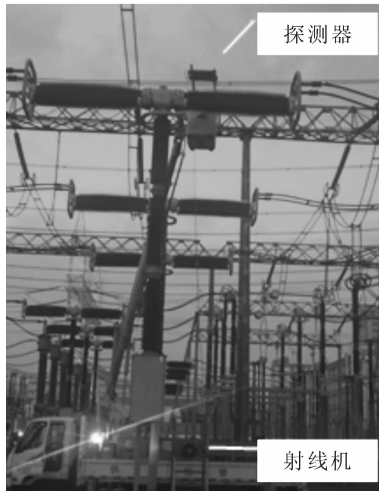
图5 X射线数字成像检测系统的现场布置
