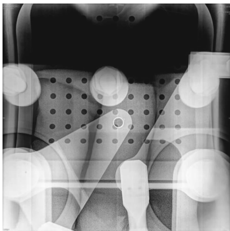
图 11 缺陷断路器曲柄机构 X 射线成像图
