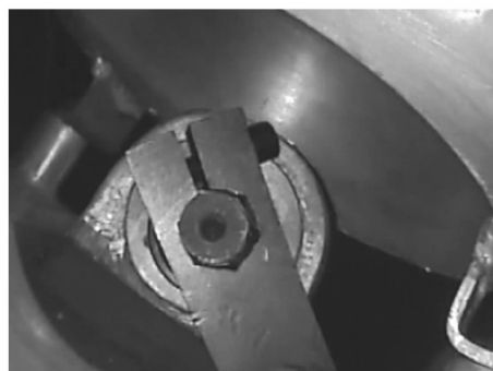
图4 缺陷开关气室内窥镜检查
